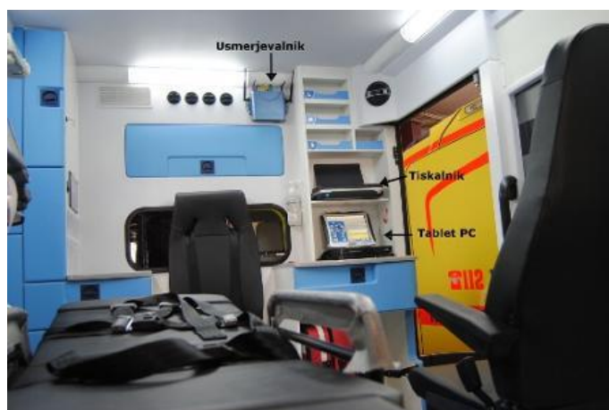
Slika 9: Oprema bolniške kabine z brezžičnim usmerjevalnikom, tabličnim računalnikom in tiskalnikom
