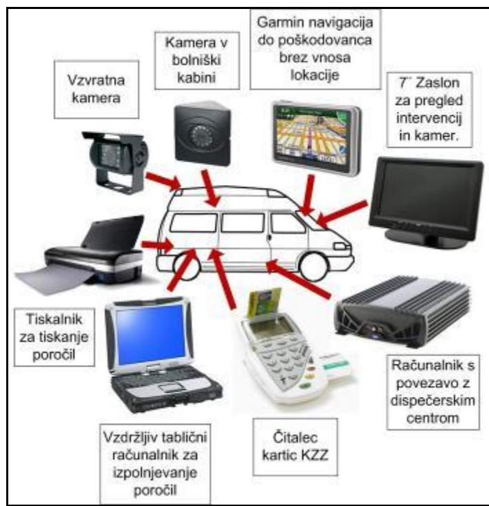
Slika 7: Reševalna vozila opremljena z rešitvama NMP3000CarPC in NMP3000mobile
