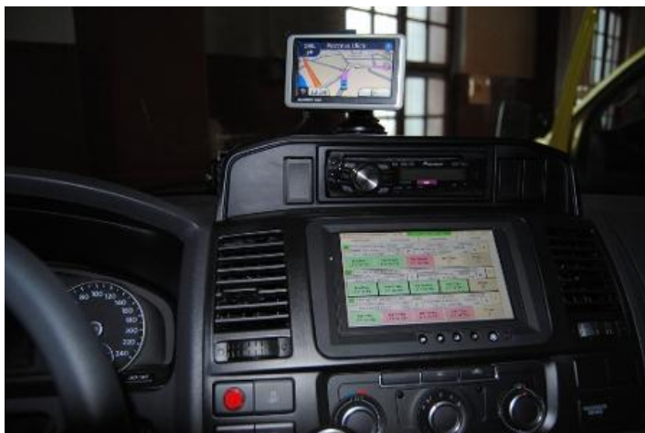
Slika 8: Oprema vozniške kabine z navigacijsko napravo in zaslonom, občutljivim na dotik
