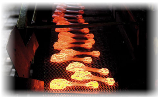
Slika 2: Odkovki med kovanjem
