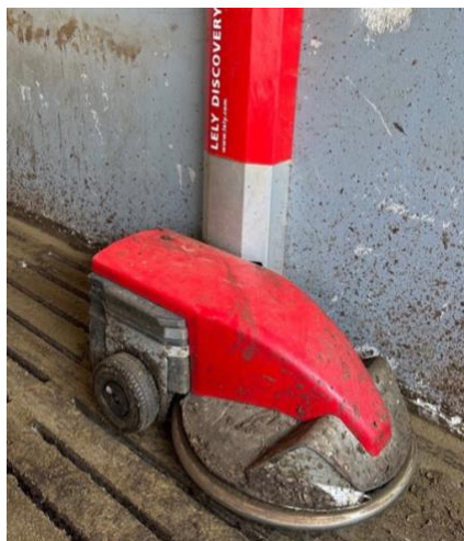
Slika 6: Čistilec rešetk Lely Discovery
