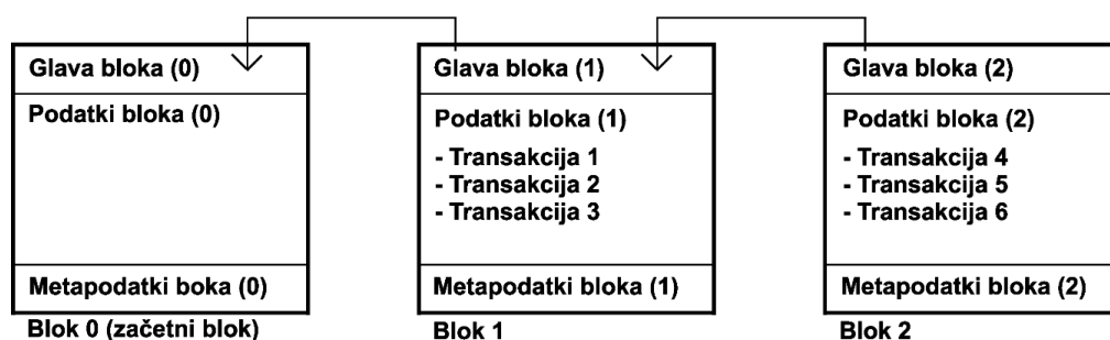
Slika 18: Arhitektura in povezava med bloki v razvojnem okolju Hyperledger Fabric
