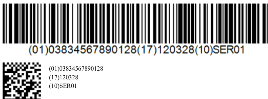
Slika 21: Primerjava velikosti GS1-128 in GS1 DataMatrix
