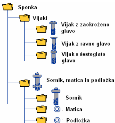
Slika 25: Primer klasifikacije – razvrstitev gradnikov v drevesno strukturo
