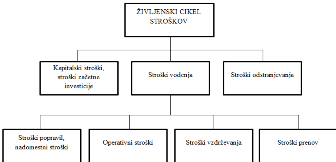
Slika 6: Elementi celotnega življenjskega cikla stroškov gradbenega projekta
