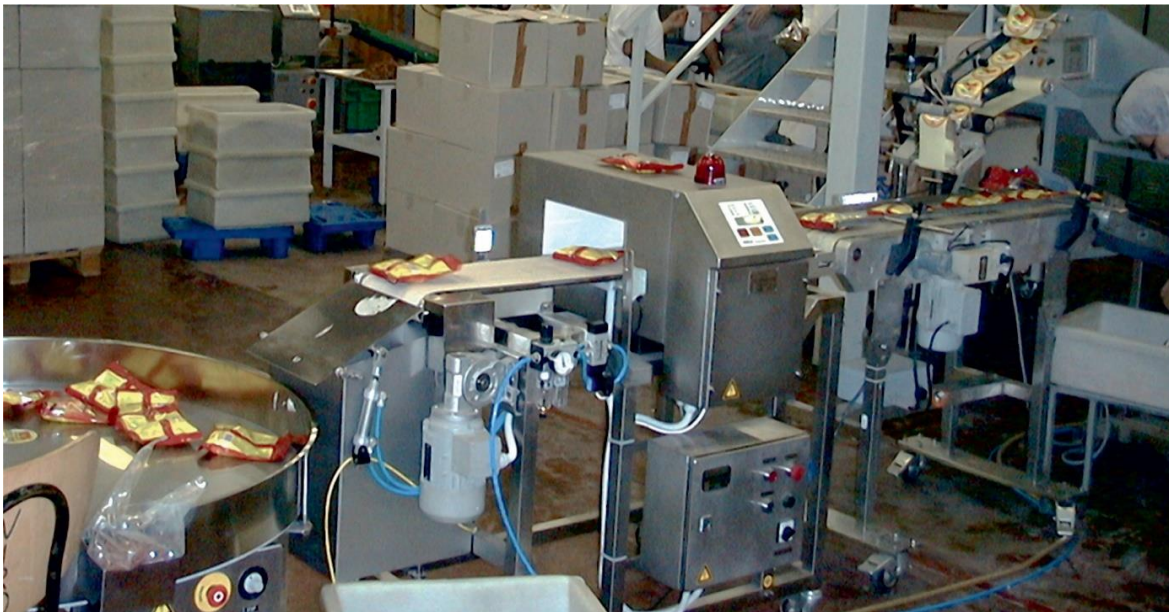
Slika 4: Detektor kovin, vgrajen za pregled pakiranih izdelkov (živilska panoga)
