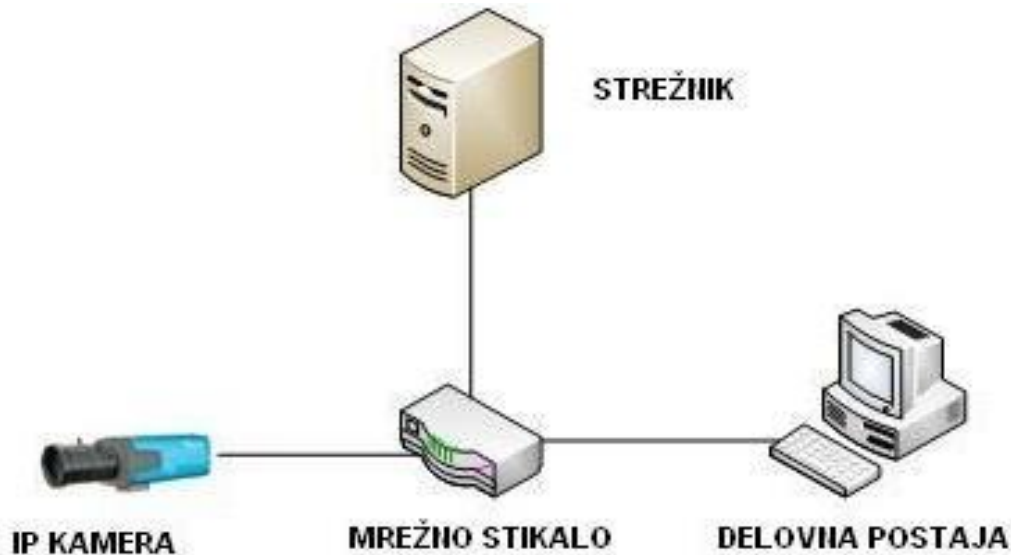
Slika 20: Shema preprostega IP video nadzornega sistema
