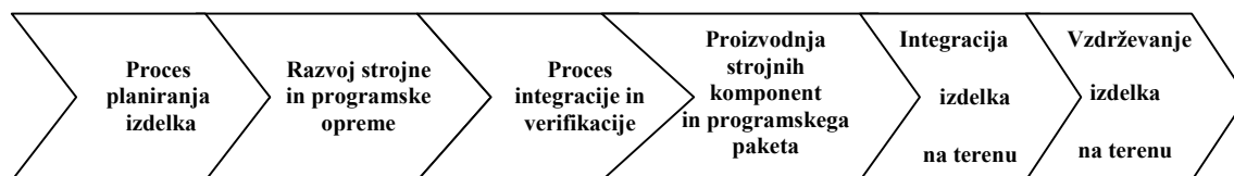
Slika 17: Proces izdelave sistema SI2000
