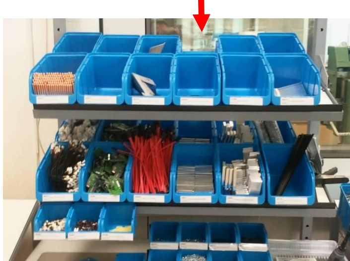
Slika 22: Sistem kanban z dvema embalažnima enotama
