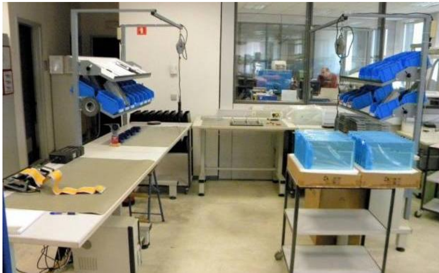
Slika 23: Postavitve celice za montažo sestava TFT
