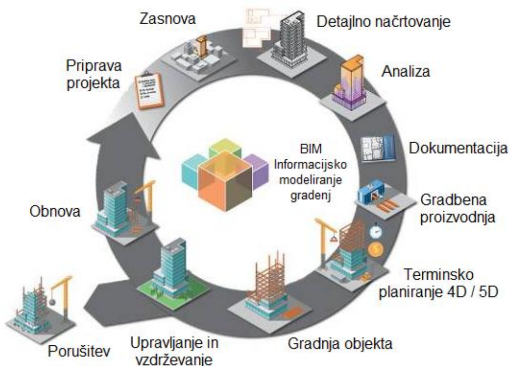
Slika 5: BIM-pristop v življenjskih fazah gradnje
