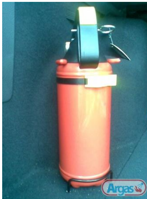
Slika 1: Gasilni aparat pod stalnim tlakom
