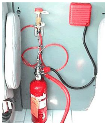
Slika 16: Firetrace avtomatski gasilni sistem za osebna vozila
