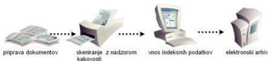
Slika 10: Shematični prikaz posameznih faz postopka optičnega branja
