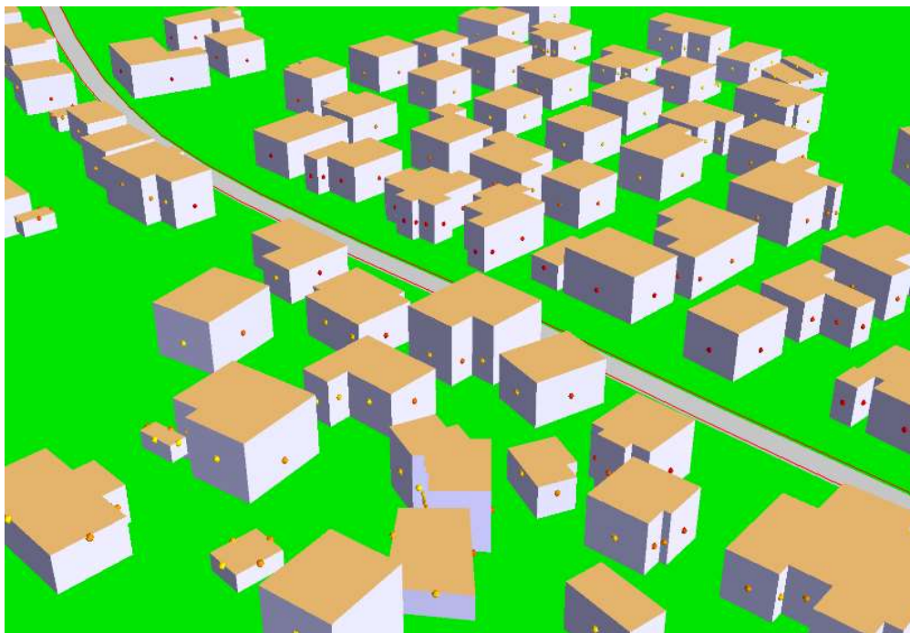
Slika 13: Sprejemniki na vsaki strani centra fasade stavbe
