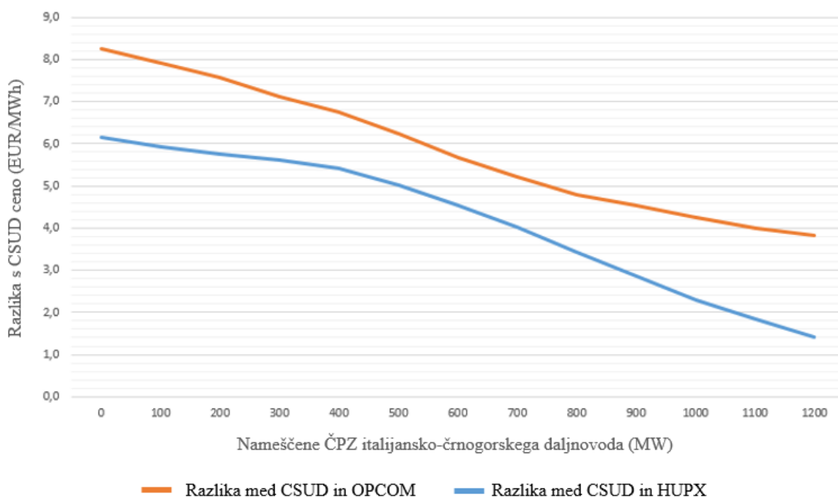
Slika 8: Razlika povprečne cene pasovne energije med CSUD ter OPCOM in HUPX ob različnih ČPZ italijansko-črnogorskega daljnovoda
