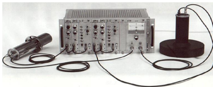
Slika 14: NIM moduli, razviti in izdelani v Laboratoriju za jedrsko elektroniko za podporo fizikalnim poskusom
