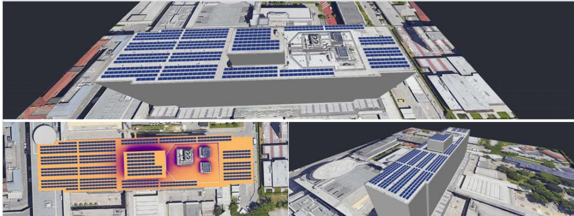
Slika 21: Postavitev PV sistema na osrednjo stavbo UKC Ljubljana
