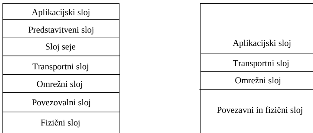
Slika 5: Primerjava slojev OSI in TCP/IP referenčnega modela
