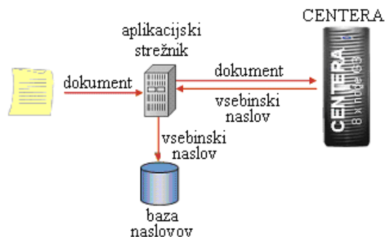
Slika 36: Arhiviranje dokumentov s sistemom Centera
