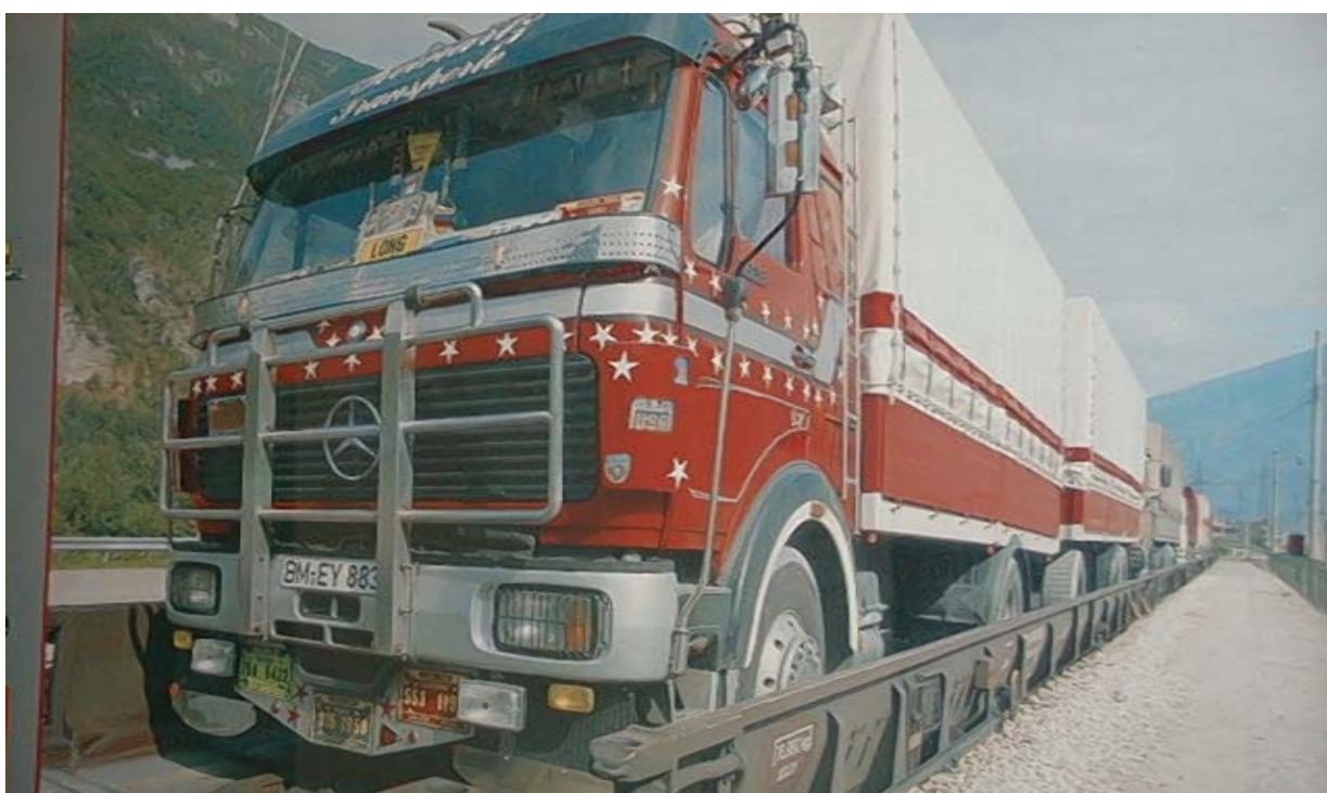
Tehnika A – prevoz kamiona na vagonu
