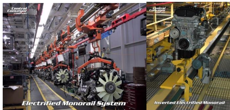
Slika 9: Primer stropnega in talnega EMS
