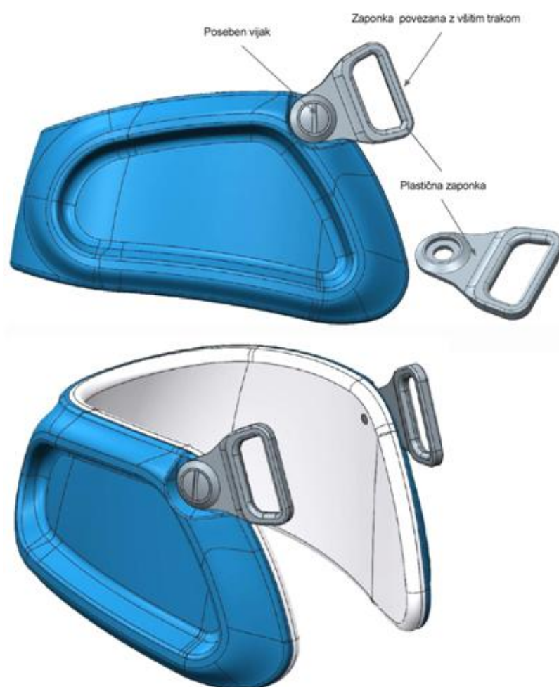
Slika p 32: Nova verzija koncepta trakov za fiksiranje 2
