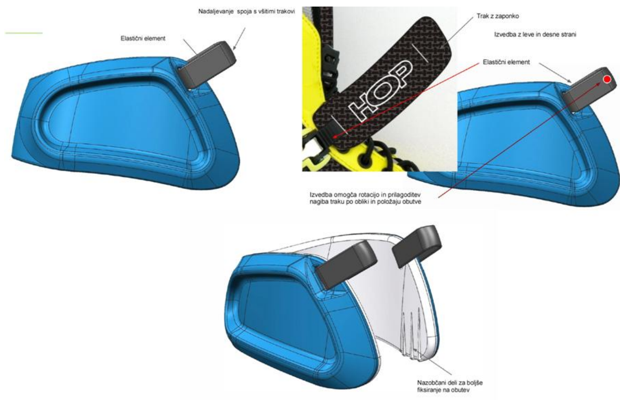
Slika p 34: Nova verzija koncepta trakov za fiksiranje 4
