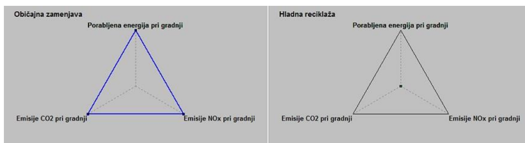
Slika 22: Primerjava emisij in porabe energije dveh načinov sanacije asfaltnega vozišča pri gradnji
