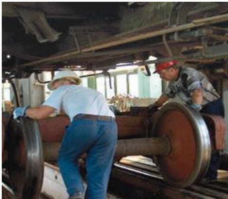
Slika 38: Menjava podvozja na vagonih
