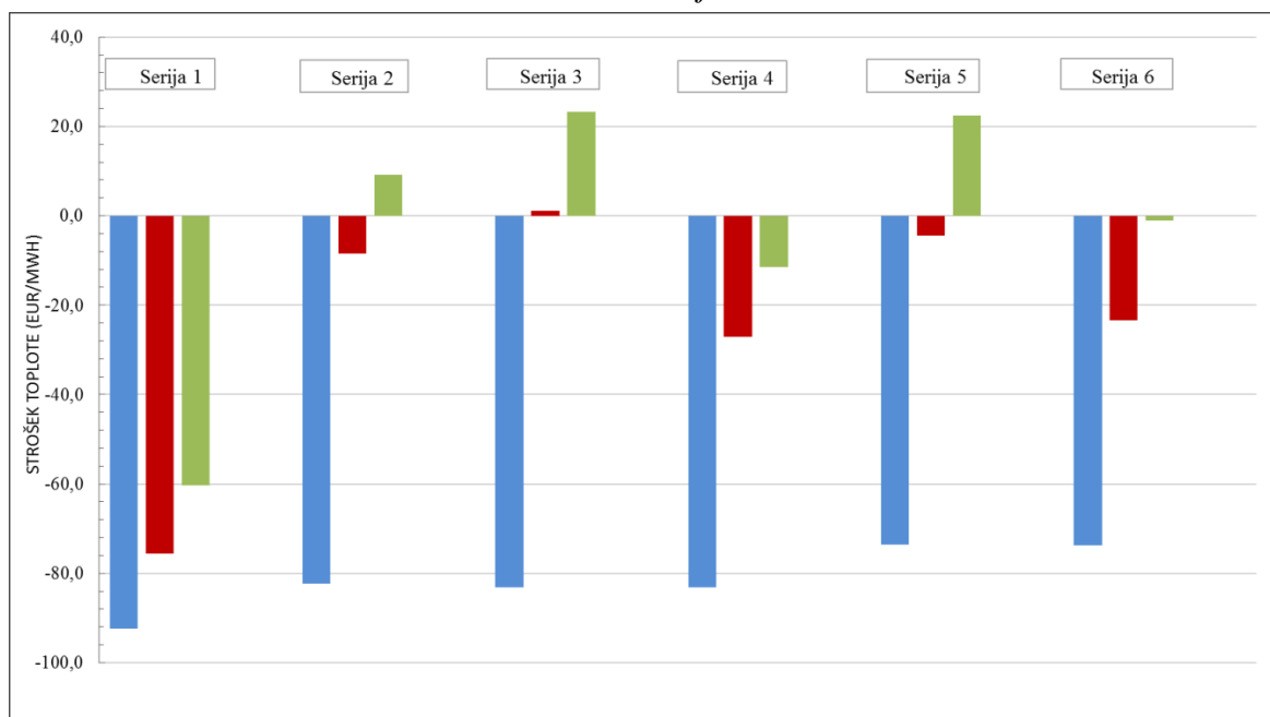
Slika 25: Strošek toplote plinskih kotlov in SPTE-naprav z OP in ZO pri 3.500 urah obratovanja.
