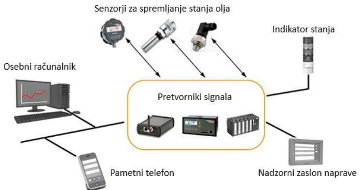
Slika 13: Struktura nadzornega sistema spremljanja stanja olja
