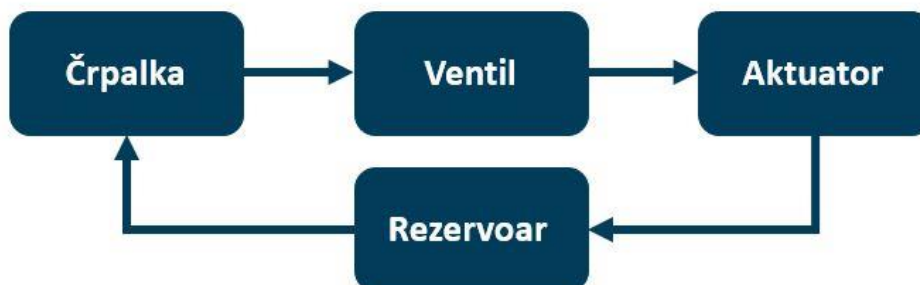
Slika 5: Shematični prikaz odprtega hidravličnega sistema
