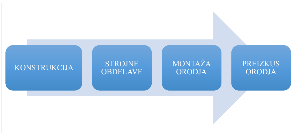
Slika 4: Proces izdelave orodja za brizganje plastičnih mas
