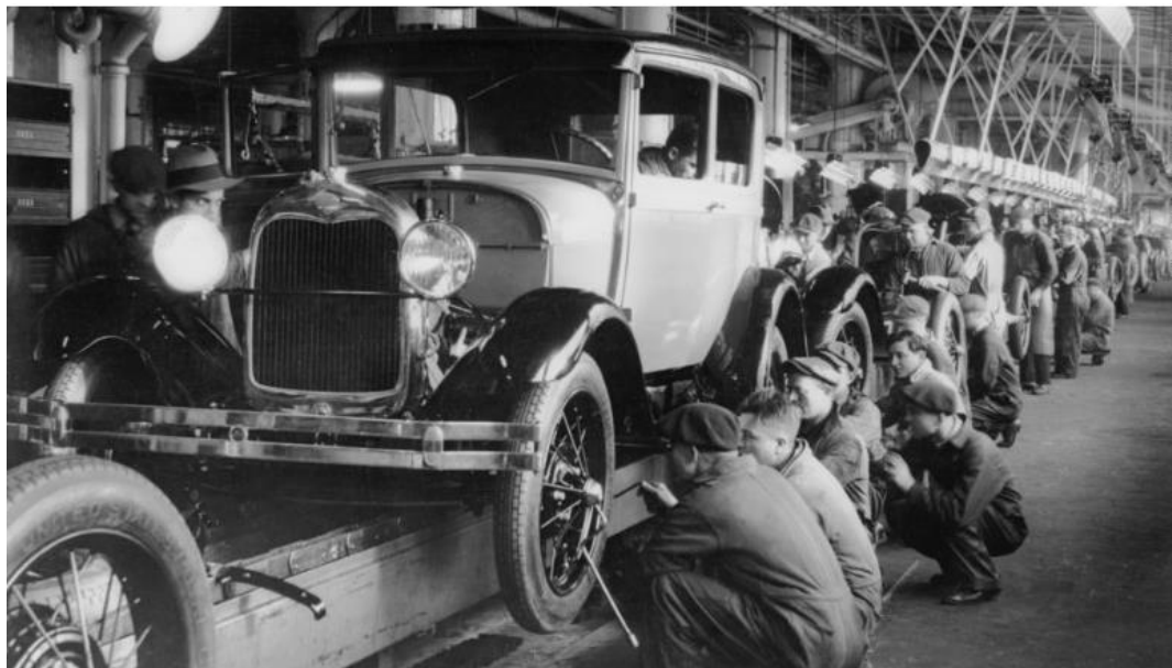
Slika 1: Tekoči trak v proizvodnji pri izdelavi modela T
