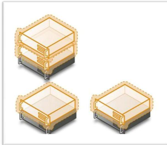
Slika 7: Prikaz delovanja virtualnih strežnikov na istem fizičnem strežniku
