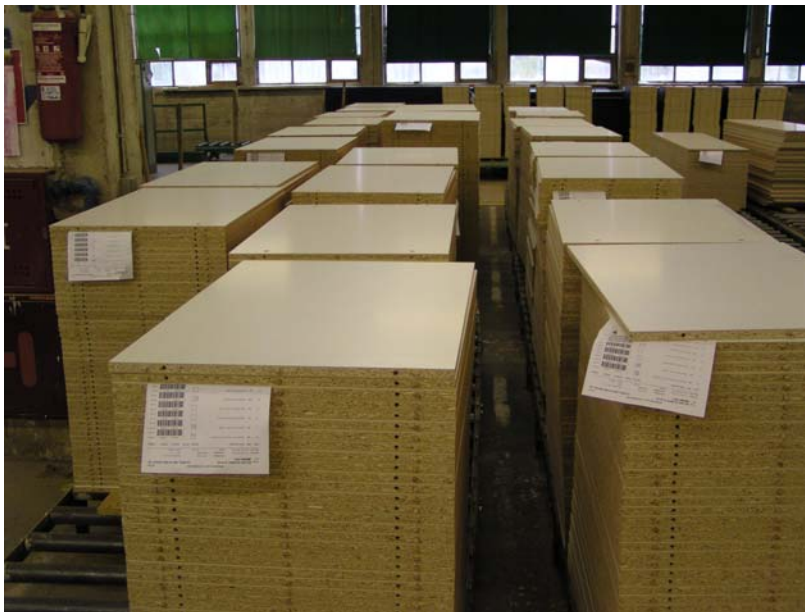
Slika 22: Palete elementov (delovne serije) opremljene s spremnim listom s črtnimi kodami
