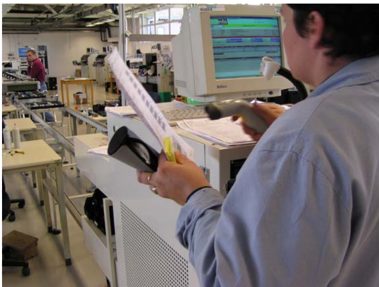
Slika 23: Vnos opravljenega dela delavca neposredno v terminal s pomočjo črtne kode.
