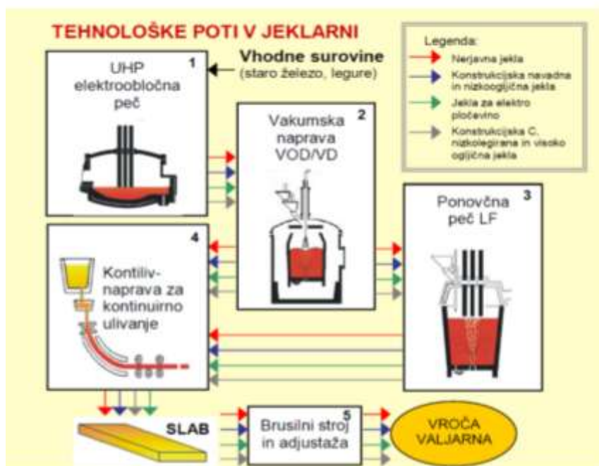
Slika 9: Tehnološka pot izdelave in litje jekla v Jeklarni
