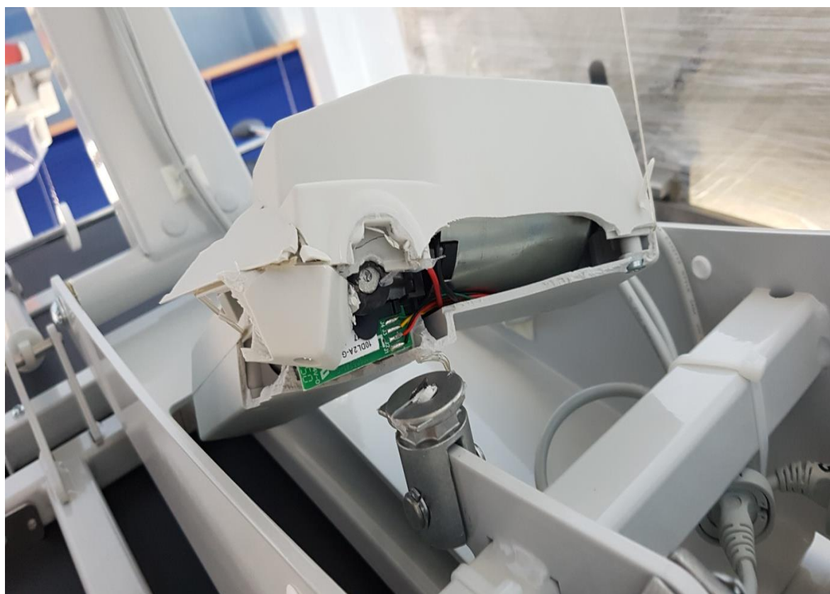
Slika 10: Poškodba glavnega motorja
