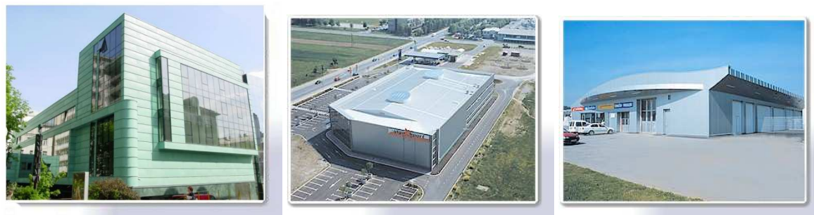
Slika 19: Primeri različnih fasadnih oblog: Grand hotel Union- patinirana bakrena pločevina; Giga Sport Celje - ognjeodporne termoizolacijske gradbene plošče; Honda Trzin - mikrolinirane plošče
