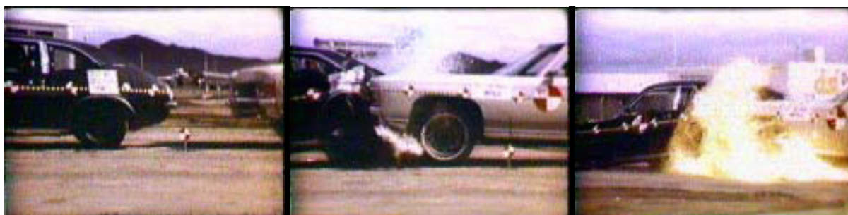
Slika 2: Vžig Ford-a Pinto pri trku v zadnji del avtomobila
