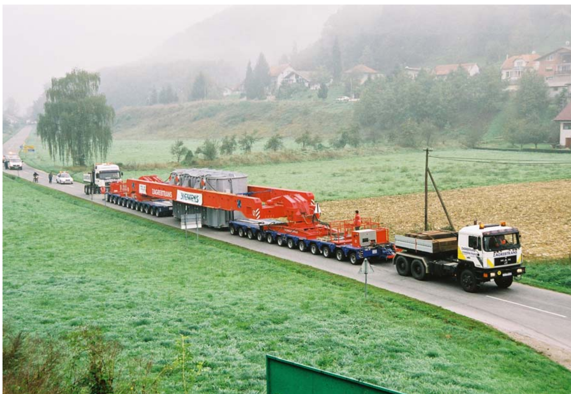
Slika 1: Prevoz transformatorja za elektrarno Krško (skupna teža 440 ton)
