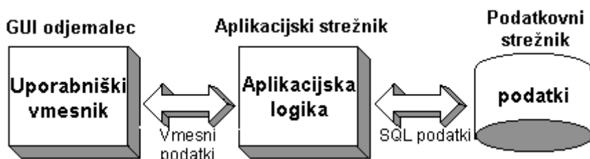
Slika 8: Arhitektura prenovljenega informacijskega sistema (tronivojski model)
