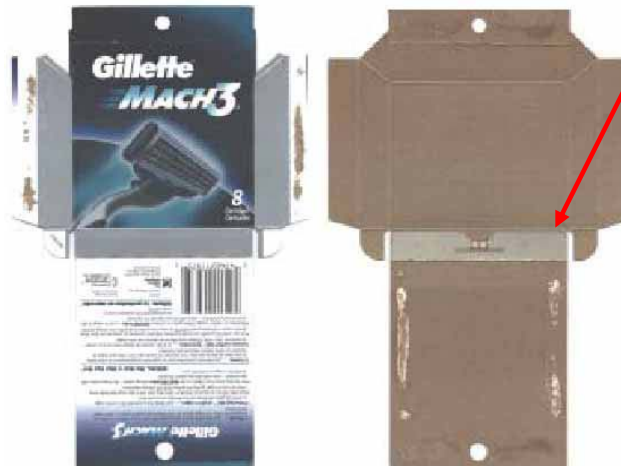
Slika 9: Mikročip, nameščen na embalaži rezil za britje
