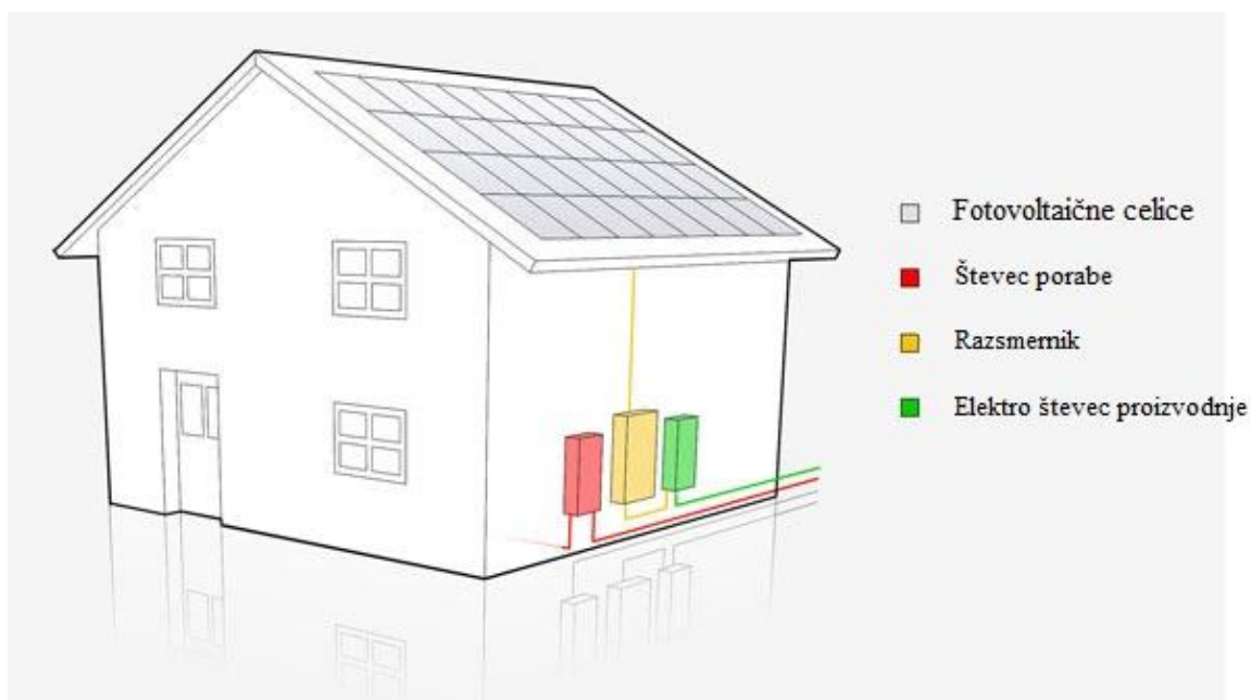
Slika 2: Kako deluje fotovoltaična elektrarna
