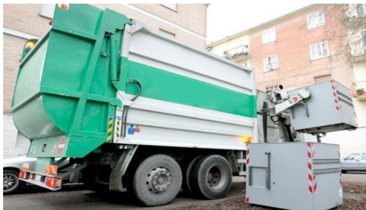
Slika 12: Opremljeno smetarsko vozilo z avtomatsko roko za praznjenje zabojnikov
