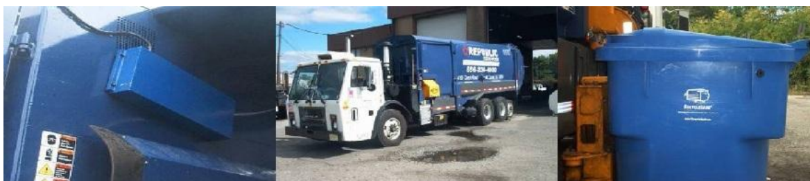
Slika 16: Vgradni prostor antene in čitalca, vozilo opremljeno s sistemom RFID in kontejner, ki ima RFID čip
