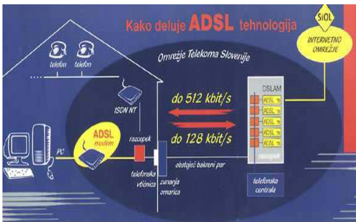
Slika 3: Delovanje ADSL tehnologije
