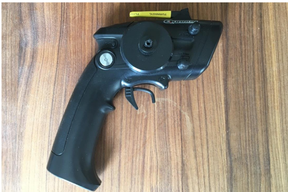
Slika 4: Pištola ali vmesnik za dodajanje hitrosti in moči električni rolki
