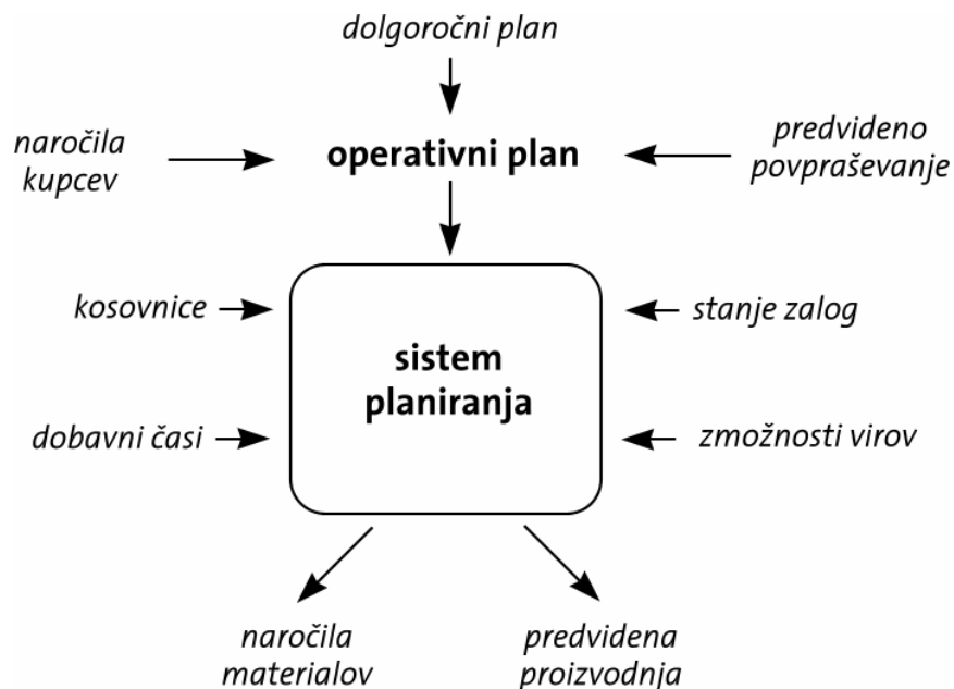
Slika 14: Struktura sistema za planiranje virov proizvodnje
