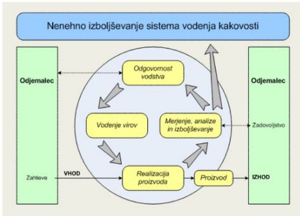
Slika 2: Model sistemov vodenja kakovosti, osnovan na procesih
