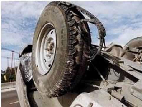
Slika 5: Poškodovana Firestonova guma
