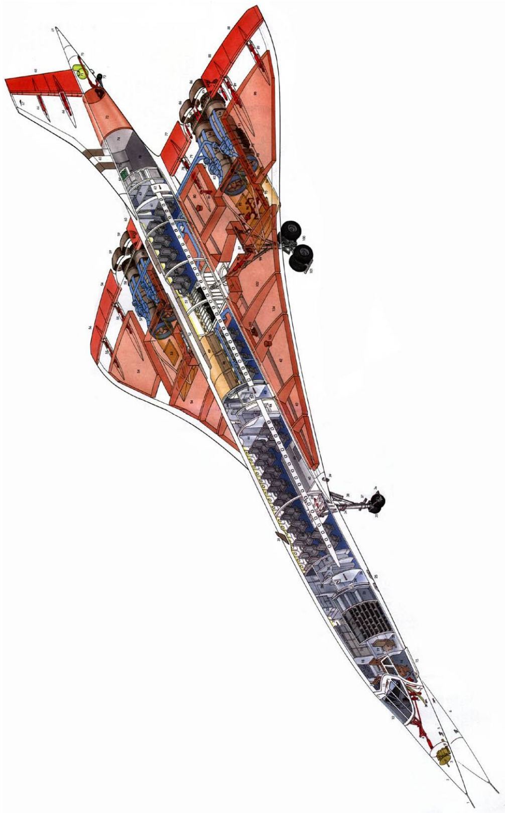
Slika 1: Prerez letala Concorde z značilnim mehanizmom spuščanja nosu (angl. droop nose ) (Vir: Concorde SST, 2006)
