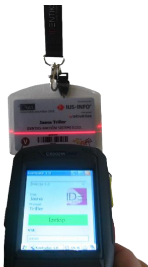
Slika 1: Zajem podatkov preko 1D kode z ročnim terminalom
