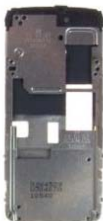
Slika 10: Aluminijasto ohišje mobilnega telefona Nokia E65
