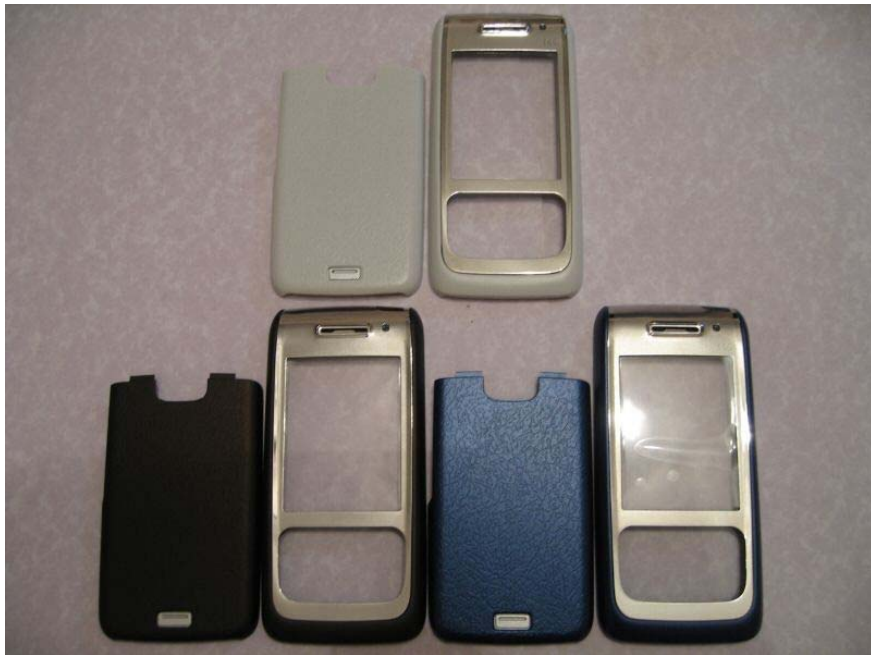
Slika 18: Plastična ohišja mobilnega telefona Nokia E65
