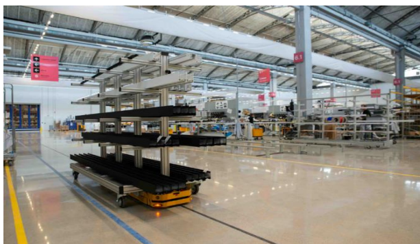
Slika 10: Robotski voziček za notranjo logistiko
