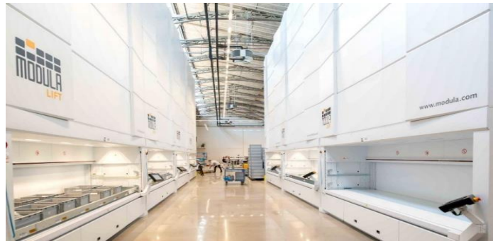
Slika 11: Vertikalne omare za shranjevanje materiala
