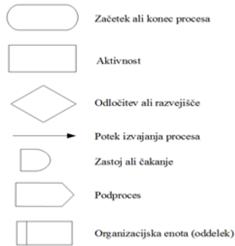
Slika 6: Simboli za modeliranje procesov s tehniko procesnih diagramov poteka
